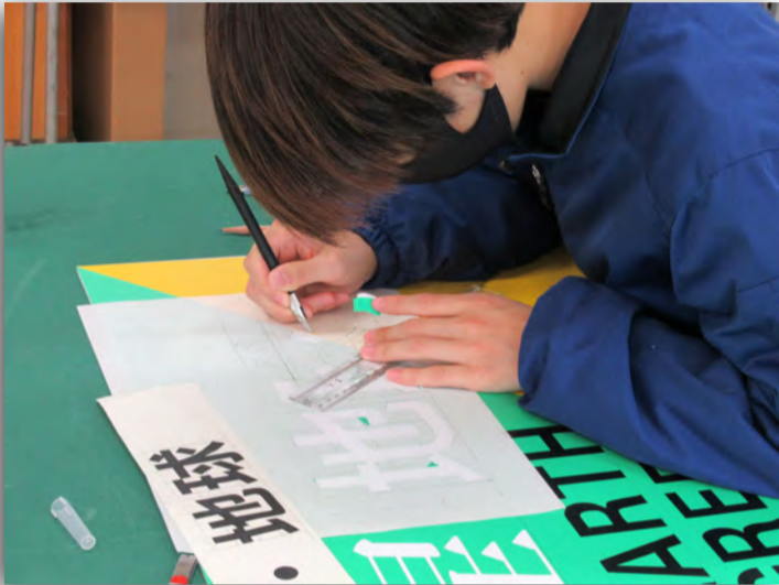
技能検定シート仕上げ1級および2級課題の練習を通してシート切り文字や突合せ貼りを学びます
